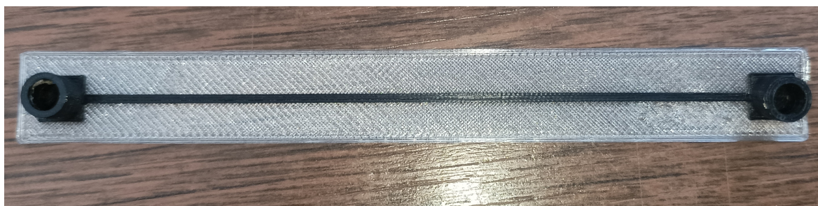
Obrázek 3.28: Fotografie tenzometru vyrobeného technologií 3D tisku
