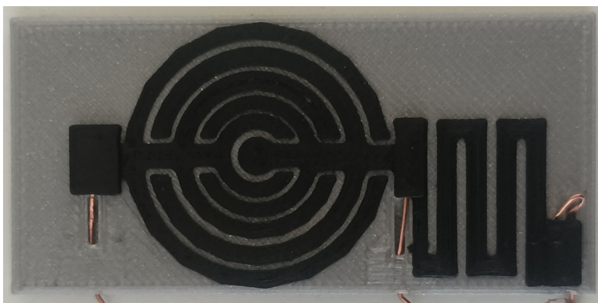
Obrázek 3.23: Tlačítko se zastrčenými vodiči
