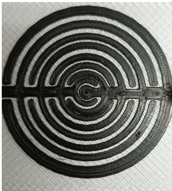
Obrázek 3.12: Výsledek tisku senzoru s kruhovými elektrodami
